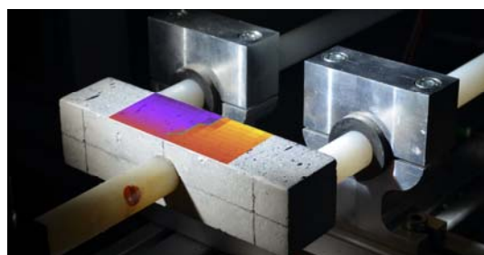
Figure 2 : Essai de flexion dynamique sur un béton
